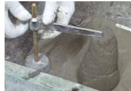
●モルタルスランプ試験
