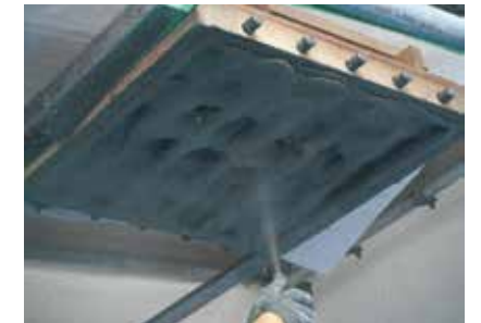
●鉄筋背面への充填性試験
