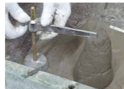
● モルタルスランプ試験
