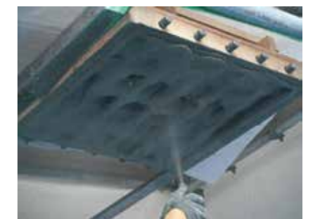
● 鉄筋背面への充填性試験
